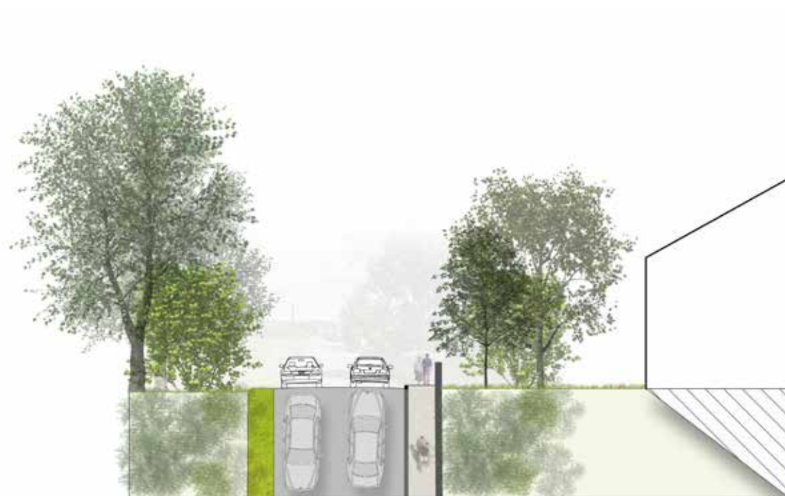
coupe de principe : création d'un trottoir le long de la RD en continuité du trottoir existant côté Est
