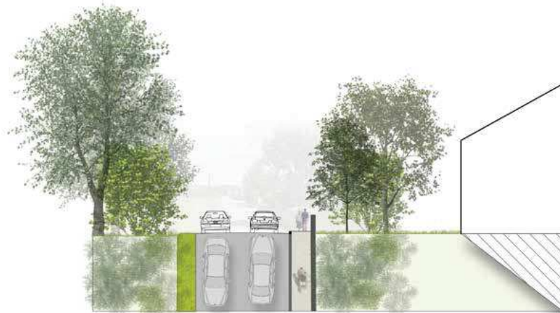
coupe de principe : création d'un trottoir le long de la RD en continuité du trottoir existant côté Est
